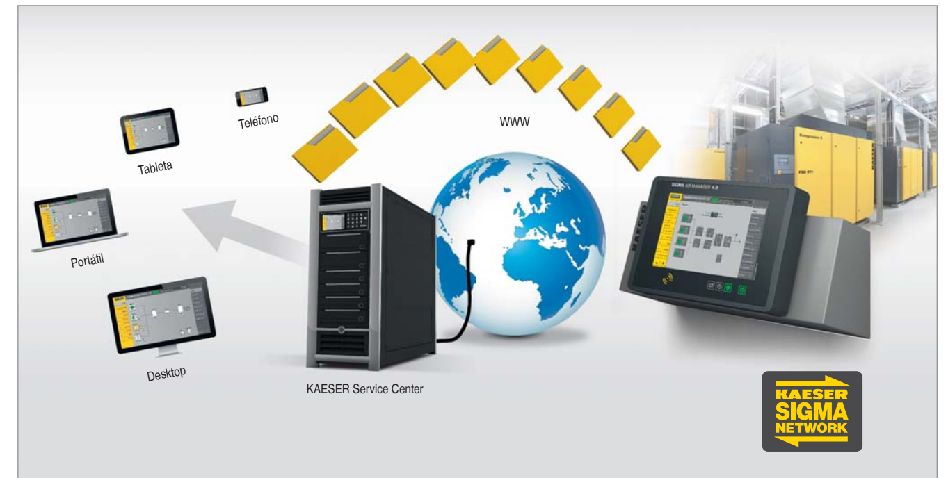
Figura 7: Las numerosas posibilidades de conexión de un controlador maestro contribuyen a un servicio más eficiente de la estación de compresores
