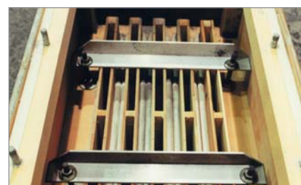
Figura 2b: Esterillas filtrantes (lado del compresor)
