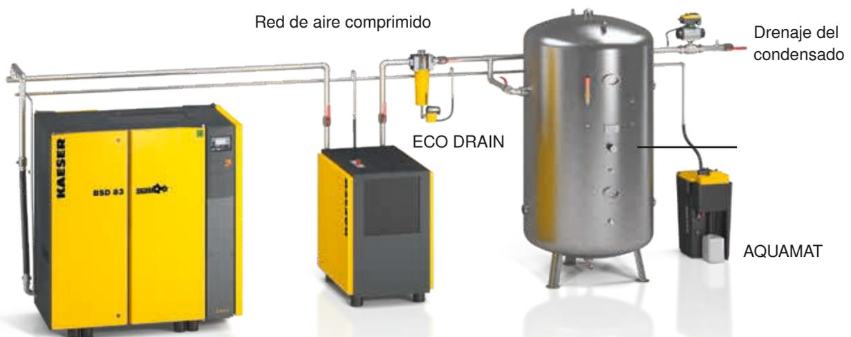
La evacuación segura de los condensados debe quedar garantizada en todos los puntos de acumulación de su sistema de aire comprimido. La mejor forma de obtenerlo es utilizar drenajes electrónicos de condensado regulados electrónicamente.
